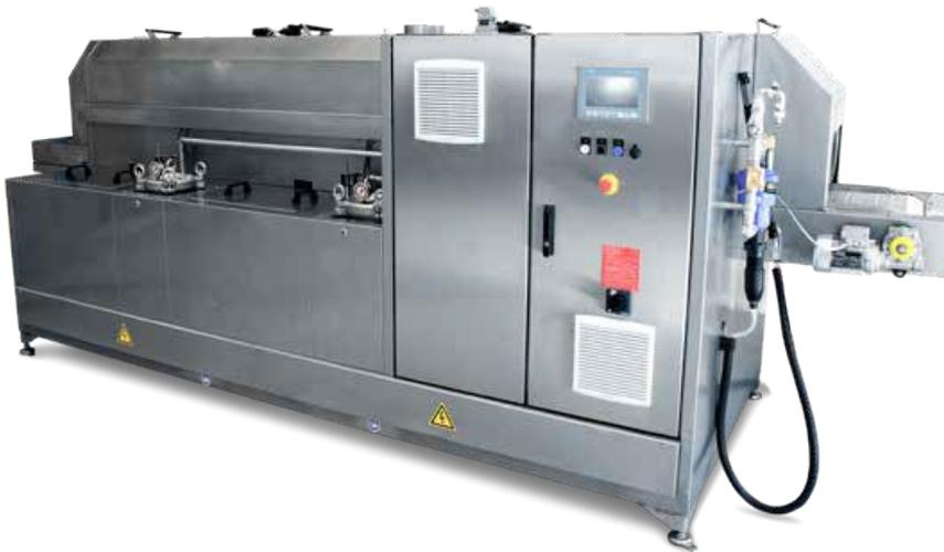
Die KSN-Bandwaschanlagen ist für den 24/7-Betrieb ausgelegt und ist die ideale Lösung für die Inline-Integration.
